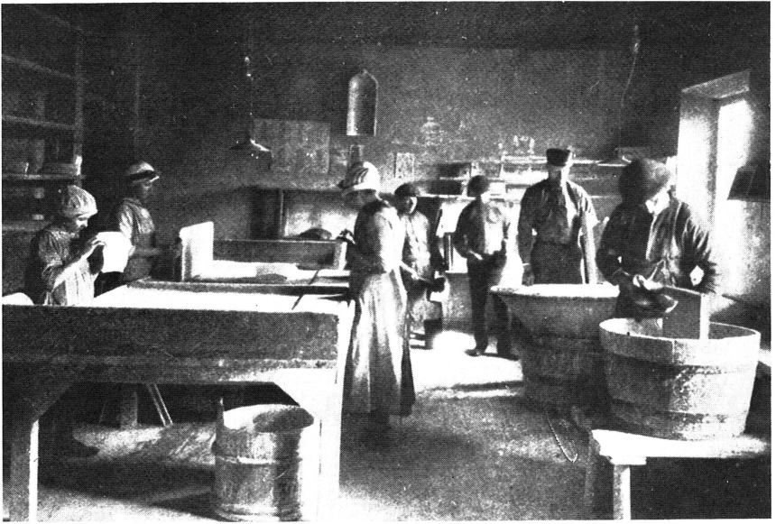
Bild 12. Glasering av kakel på Uppsala-Ekeby AB på 1910-talet. Till höger glaserare som håller glasyr över kaklen, till vänster skrapas överflödig glasyr bort. Foto ur Svensk industri i ord och bild. Göteborg 1919.
