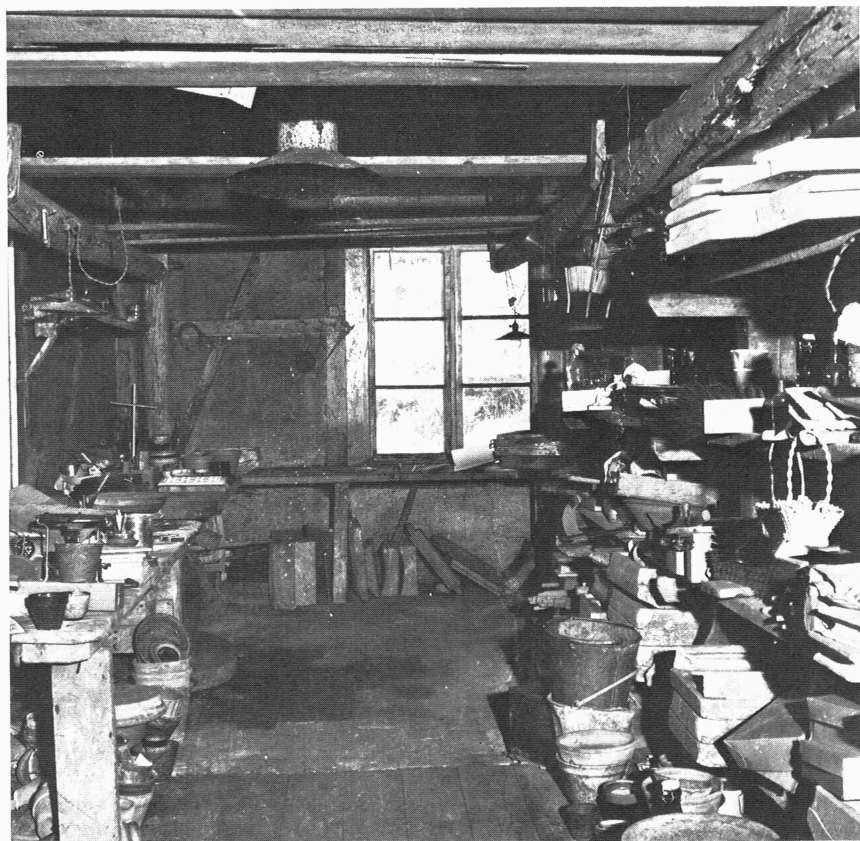
Bild 7. Nedre verkstaden. Rakt fram arbetsbänk med formskiva på vilken bladkaklen formades. Till höger hyllor där kaklen ställdes på tork. På de undre hyllorna syns några kakelformar. Till vänster arbetsbänk och sparkdriven drejskiva. Foto Lars Gezelius 1970. UFF.
