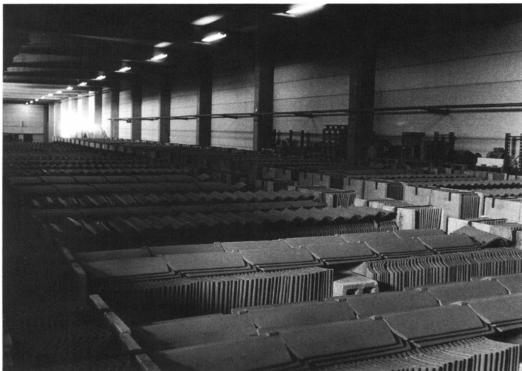
På ett spår står vagnar med tegel som skall brännas och på ett annat vagnar med bränt tegel som skall sorteras. Foto Tommy Arvidson.
