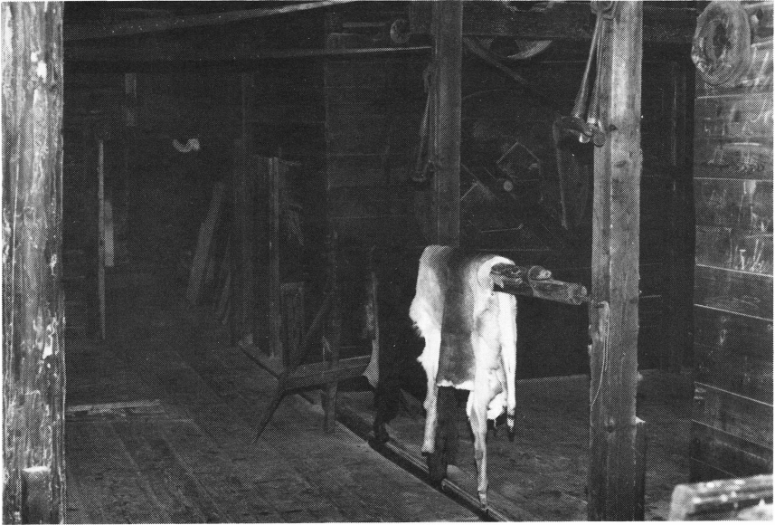
I sträckramen sträcktes pälskinnen. Nolmyrabro garveri 1984. Foto: Karin Blent.
