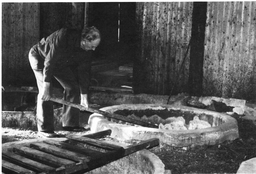
Henning Hofvander visar hur det kunde gå till i drivhuset när man rörde om hudarna i barklagen med hjälp av en drivkäpp. Nolmyrabro garveri 1984. Foto: Karin Blent.
