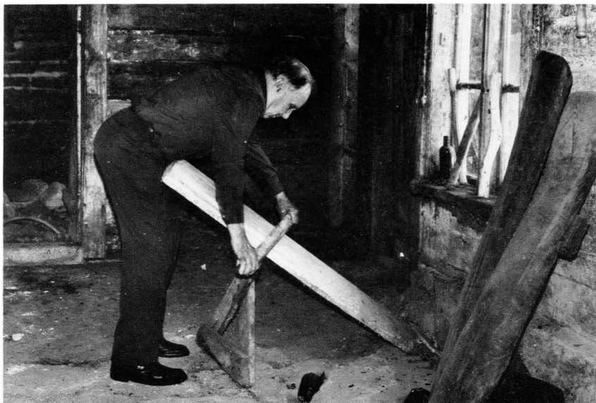
Vid bommen demonstrerar Henning Hofvander hur man med hjälp av en skärdegel rensade hudens köttssida. Nolmyrabro garveri 1984. Foto: Karin Blent.
