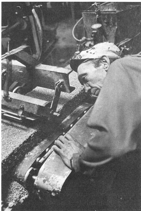
Bild 18. Reparator Gunnar Hultkvist kon- trollerar valsen på skärbordet.
