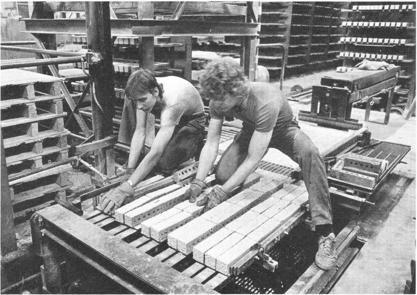
Bild 11. Peter Bohlin och Peter Strömgren placerar "petringarna" rätt innan de lyfts över till torkvagnen.
