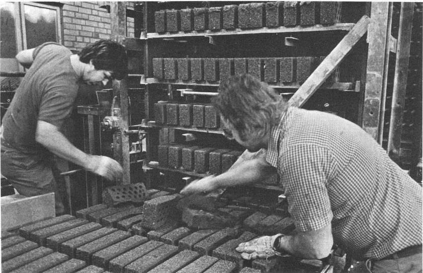
Bild 9. Trassel vid höjelevatorn. Christer Wahlberg och Heikki får rycka in och lägga stegenarna till rätta för hand.
