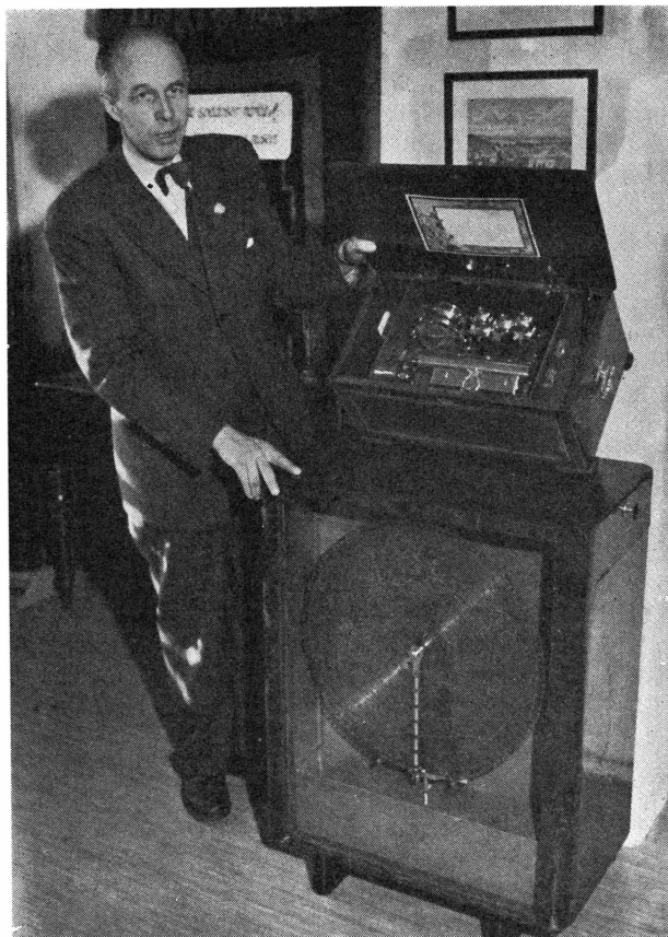
Bild 4. Författaren demonstrerar en polyphon med notskivor med 50 cm:s diameter och en speldosa med trumma och klockor.
